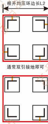
接地均压环满足接地电阻要求时的施工方法
